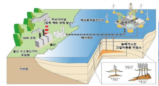
동해가스전 활용 CCS 통합실증 사업 개념도 [산업통상자원부 제공, 재판매 및 DB 금지]
